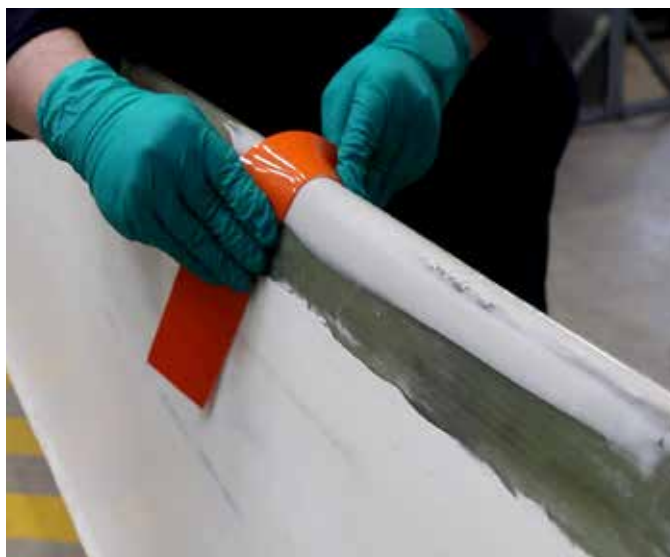
Bord d'attaque facile à profiler, pas besoin de ponçage.
