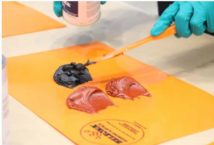
Pour mélanger de petites quantités de Belzona<sup>®</sup> 4301, utiliser 2 parts de base pour 1 part de durcisseur en volume.
