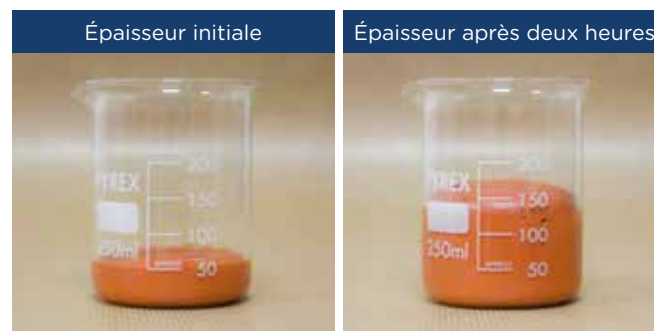
Expansion de la mousse Belzona 5871 après deux heures
